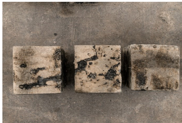
Gambar 1. Benda Uji Komposit Mortar ECC-Kerikil Aspal Porus
