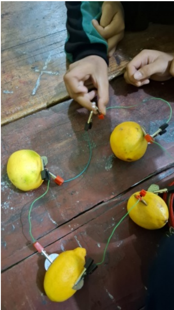
Figure 2. Hasil percobaan membuat sumber energi listrik alternatif dari buah
