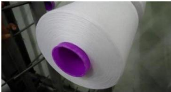
Gambar 2.3 Cacat Benang Tanpa Ekor
